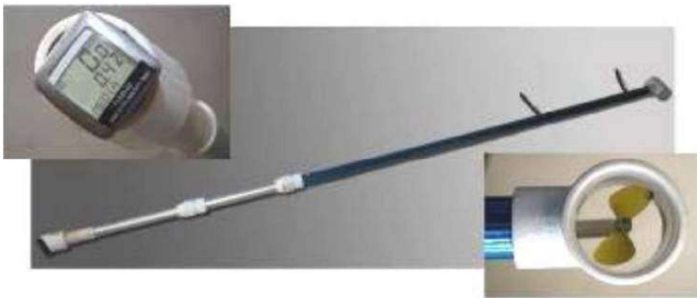
Figura 5.1. Correntometro (o mulinello) utilizzato, particolare del display e della testa.
