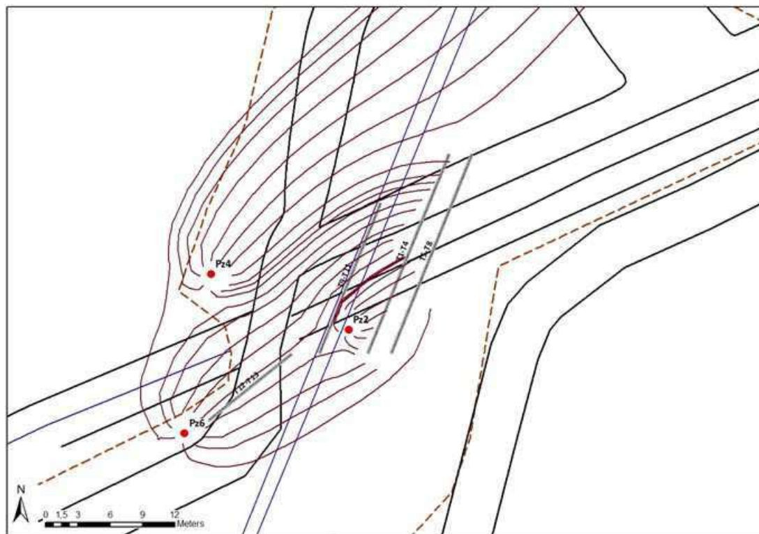
FIGURA 32 – SCENARIO 2 - OUTPUT DEL PARTICLE TRACKING CON IL SISTEMA DI BARRIERAMENTO ATTIVO E LA REIMMISSIONE IN TRINCEE T1-T8. SONO RAPPRESENTATE IL TRACCIATO DELLE PARTICELLE IN PARTENZA DALLE TRINCEE T1 E T2 E L'AREA DI CATTURA DEI PIEZOMETRI PZ2, PZ4 E PZ6
